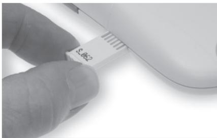
Asegúrese de que el medidor esté apagado. Cuando el código esté ubicado hacia arriba, coloque el chip codificado en la ranura hasta que encaje en su lugar.
