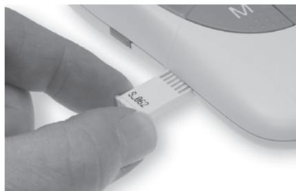
Deslice el chip codificado nuevo en la ranura para chip codificado hasta que encaje en su lugar.
