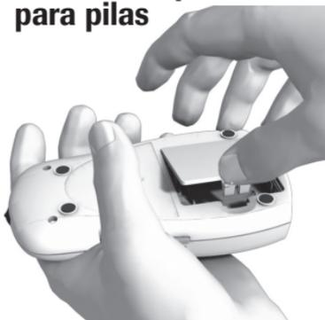
Cuando el medidor esté apagado, gírelo. Presione el pestillo ligeramente hacia adentro y levante la tapa. Quite las pilas antiguas, si fuera necesario.
