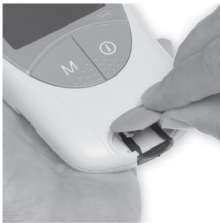
Cuando el medidor esté apagado, use la uña del pulgar para abrir la tapa de la guía de tiras reactivas presionando el borde delantero hacia arriba.
