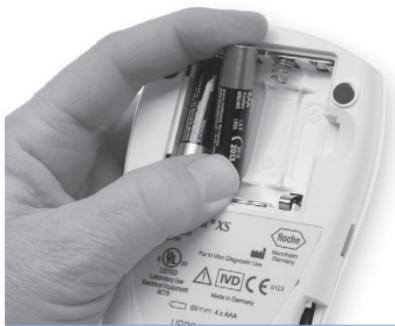
Coloque las pilas según se muestra en el diagrama que se encuentra dentro del compartimiento de las pilas. Vuelva a colocar la tapa. Vuelva a girar el medidor.
